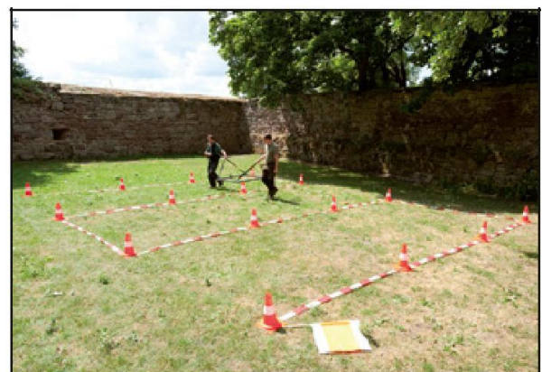
تصویر ۱۳. شیوه پیمایش میدانی با کویل بزرگ در عملگر DLOG
